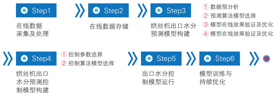
图5-16 基于CPS的烘丝机出口水分预测与控制系统
