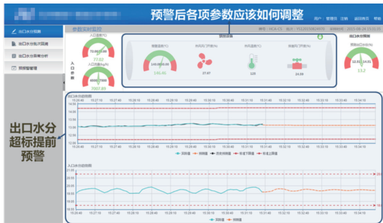
图5-17 烘丝机出口水分预测及调整建议
