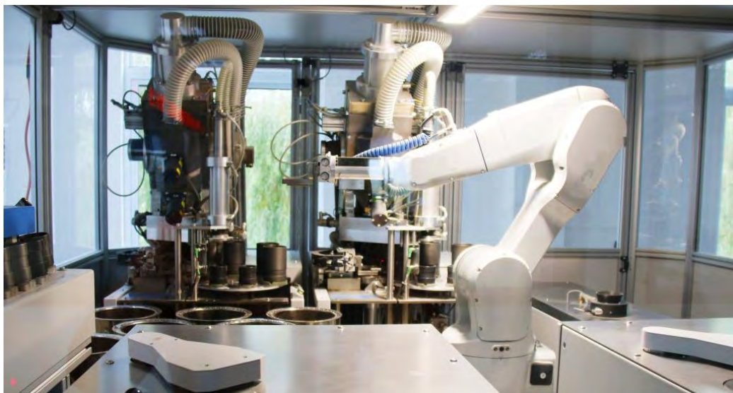
图 5 智能质量控制系统—自动制样机械手
