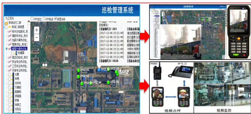
图 14 九江石化智能工厂 4G 智能终端巡检系统
