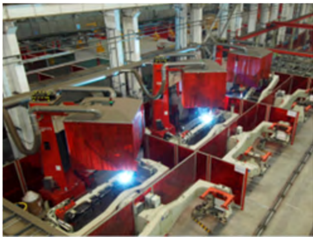
图 4 中车青岛四方构架自动焊接生产线
